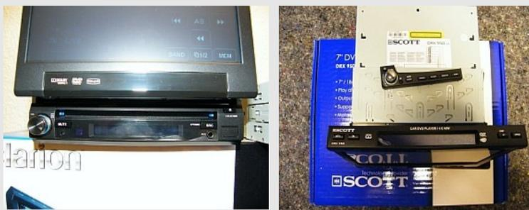
Beim Clarion ist das Display im Hauptgerät untergebracht, beim Scott auf der Kopfseite im Monitor. Als Diebstahlschutz bietet der Scott ein kleines abnehmbares Bedienteil.
